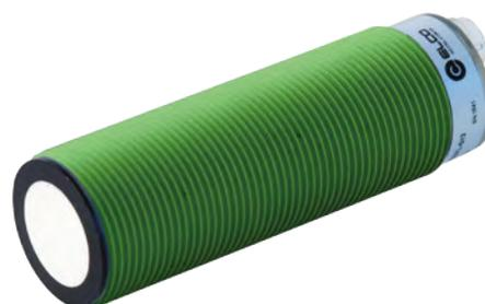
Ультразвуковой датчик KTSU представляет собой бесконтактный датчик, предназначенный для контроля положения объектов из любого материала. Ультразвуковые датчики широко используются для решения задач АСУ ТП. Выполняются с нормально разомкнутым/нормально замкнутым контактом и аналоговым выходом
