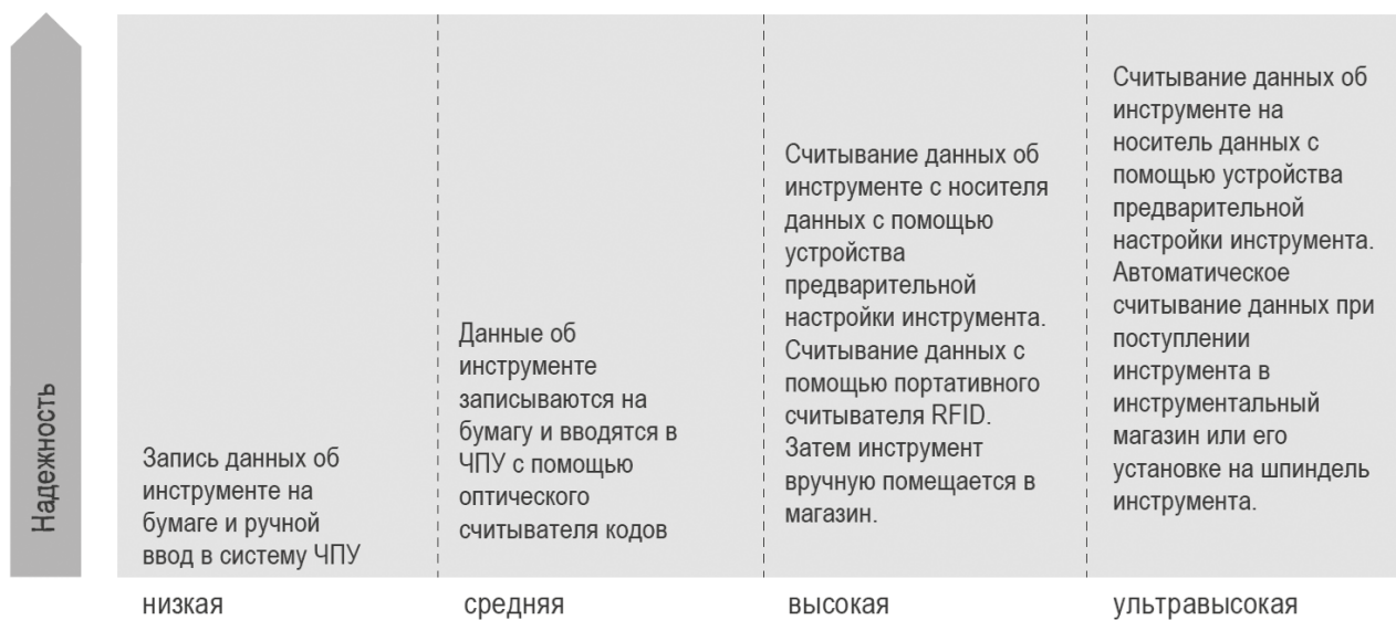
Рис. 2. По мере повышения уровня автоматизации повышается надежность распределения инструментов
