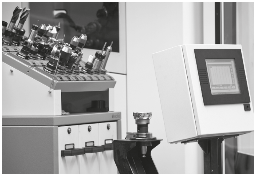
Рис. 12. Упрощенная версия системы идентификации инструмента EASY TOOL-ID
