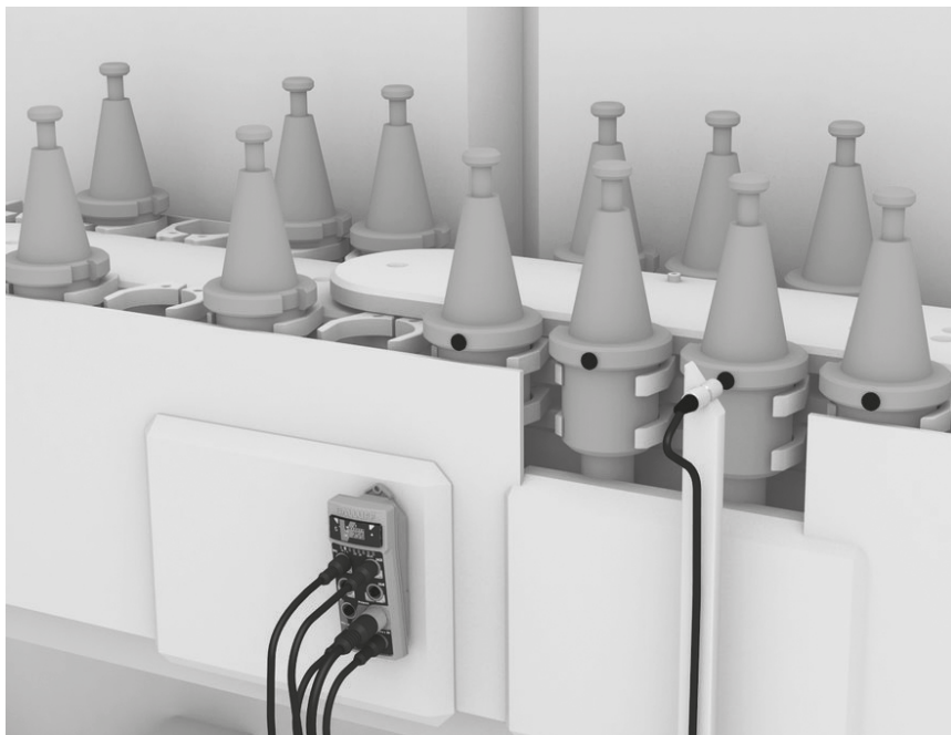
Рис. 10. Автоматическая идентификация инструмента на складе на базе системы TOOL-ID BALLUFF
