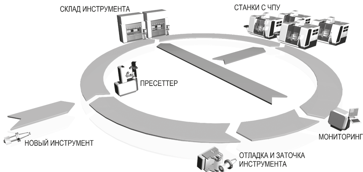
Рис. 11. Основной принцип системы идентификации инструментов TOOL-ID
