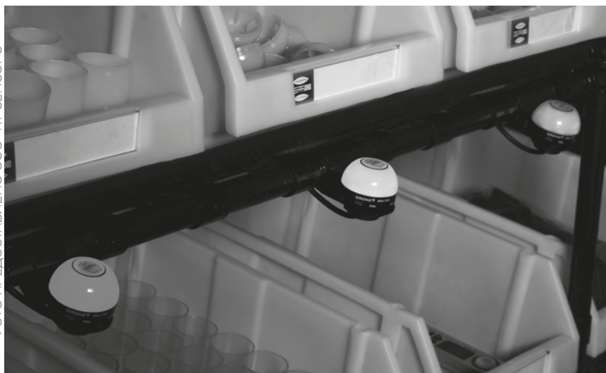
Система Pick-to-light призвана минимизировать вероятность ошибок, обеспечить скорость и отлаженность процесса
