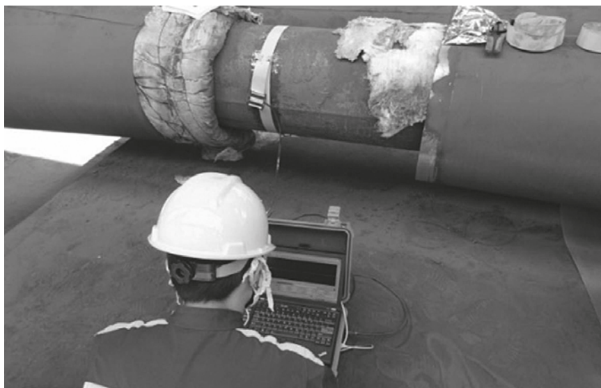
Технология неразрушающего контроля трубопроводов и крупномасштабных конструкций – сканирование ультразвуковой направленной волной с использованием магнитострикционного эффекта
