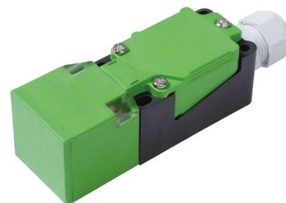
Индуктивный датчик KTSI представляет собой бесконтактный датчик, предназначенный для контроля положения объектов из металла. Индуктивные датчики широко используются для решения задач АСУ ТП. Выполняются с нормально разомкнутым, нормально замкнутым и переключающим контактом.
