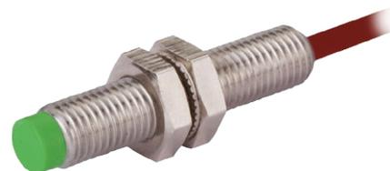
Индуктивный датчик KTSI представляет собой бесконтактный датчик, предназначенный для контроля положения объектов из металла. Индуктивные датчики широко используются для решения задач АСУ ТП. Выполняются с нормально разомкнутым или нормально замкнутым контактом.
