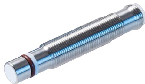
Индуктивный датчик KTSI на высокое давление представляет собой бесконтактный датчик, предназначенный для контроля положения штока гидроцилиндра. Индуктивные датчики широко используются для решения задач АСУ ТП. Выполняются с нормально разомкнутым или нормально замкнутым контактом.
