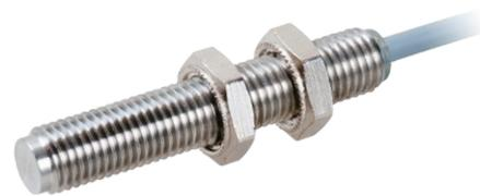
Индуктивный датчик KTSI представляет собой бесконтактный датчик, предназначенный для контроля положения объектов из металла. Индуктивные датчики широко используются для решения задач АСУ ТП. Выполняются с нормально разомкнутым или нормально замкнутым контактом.
