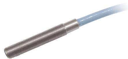
Индуктивный датчик KTSI представляет собой бесконтактный датчик, предназначенный для контроля положения объектов из металла. Индуктивные датчики широко используются для решения задач АСУ ТП. Выполняются с нормально разомкнутым или нормально замкнутым контактом.
