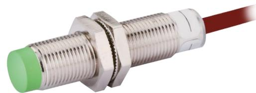
Индуктивный датчик KTSI представляет собой бесконтактный датчик, предназначенный для контроля положения объектов из металла. Индуктивные датчики широко используются для решения задач АСУ ТП. Выполняются с нормально разомкнутым или нормально замкнутым контактом.
