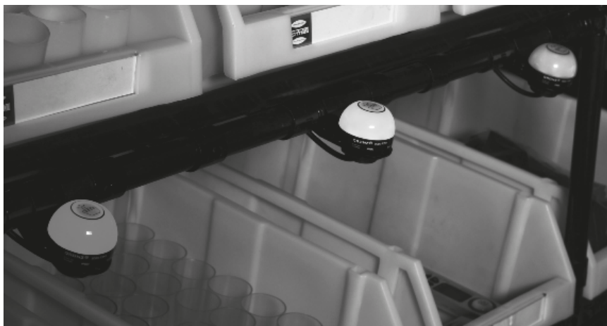
Рис. 1. Простейший вариант исполнения системы Pick-to-Light
