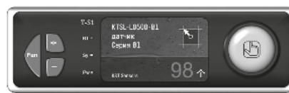
Рис. 3. Примеры различных вариантов дисплеев электронных этикеток с регулируемым размещением
