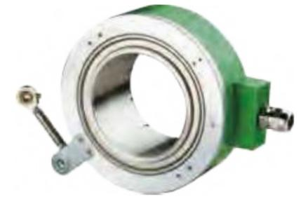
Инкрементный энкодер с большим полым валом Heavudic EV90P специально разработан для тяжелой промышленности и тяжелонагруженных валов. Он обеспечивает превосходную устойчивость к механическим ударам и способен выдерживать более высокие осевые и радиальные нагрузки. Его можно установить непосредственно на приводной вал с помощью монтажной штанги или монтажной пластины.
