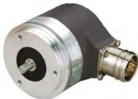
Энкодеры серии Torpid EV58A с двойным подшипником широко используются в промышленных условиях. Они обеспечивают высокую производительность и обладают высокой ударопрочностью. Энкодеры выполнены из нержавеющей стали, имеет полый вал макс.  $\phi 15$  мм и способен выдержать более высокие осевые и радиальные нагрузки. Энкодеры имеют защиту от перенапряжения, неправильного подключения и короткого замыкания.
