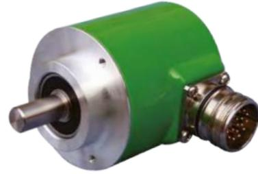
Абсолютный однооборотный энкодер с аналоговым выходом 4–20 мА серии EAC58 отличается компактной конструкцией и высокой устойчивостью к механическим повреждениям и более высоким осевым и радиальным нагрузкам. Серия EAC58 оснащена функцией RESET и имеет разрешение до 8192имп/об. Выход 4–20 мА совместим с промышленными контроллерами.
