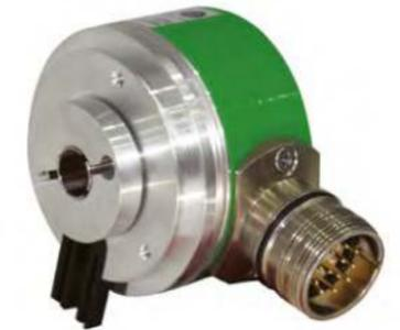
Абсолютный однооборотный энкодер серии EAC58P может широко использоваться в различных промышленных условиях. Эта серия также обладает хорошей устойчивостью к механическим повреждениям и может выдерживать более высокие осевые и радиальные нагрузки. Доступны различные типы фланцев и соединений. Серия EAC58P также имеет функцию RESET и разрешение до 8192 имп/об.
