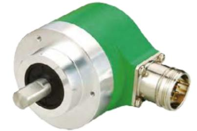
Абсолютный однооборотный энкодер серии EAC58 standard может широко использоваться в различных промышленных условиях. Эта серия также обладает хорошей устойчивостью к механическим повреждениям и может выдерживать более высокие осевые и радиальные нагрузки. Доступны различные типы фланцев и соединений. Серия EAC58 также имеет функцию RESET и разрешение до 8192 имп/об.
