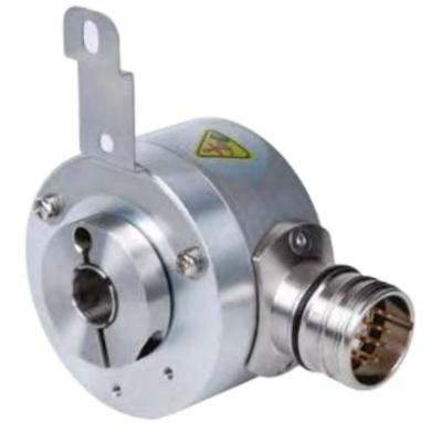
Энкодеры серии Torquid EV58P с двойным подшипником широко используются в промышленных условиях. Они обеспечивают высокую производительность и обладают высокой ударопрочностью. Энкодеры выполнены из нержавеющей стали, имеет полый вал макс. Ø15мм и способен выдержать более высокие осевые и радиальные нагрузки. Энкодеры имеют защиту от перенапряжения, неправильного подключения и короткого замыкания.
