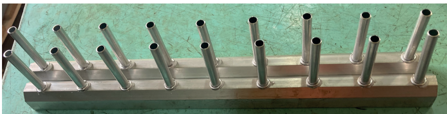
Рис. 3. Готовые тонкостенные алюминиевые трубы после пайки
