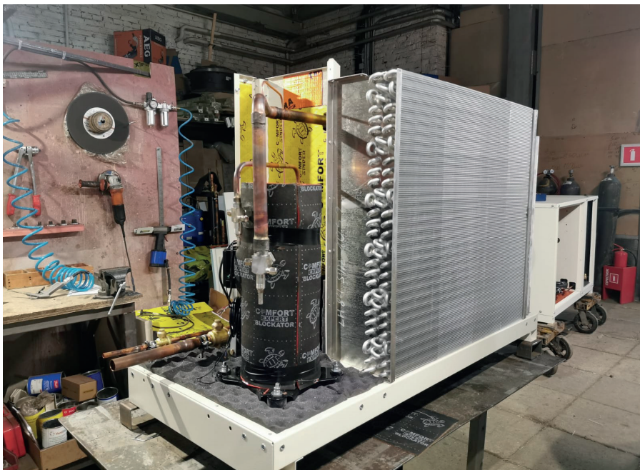
Рис. 4. Станция охлаждения «Мегахолод» с алюминиевым теплообменником
