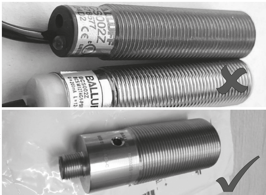
Рис. 2. На подделках маркировка наносится краской или наклейкой. В оригинале — лазерной гравировкой
